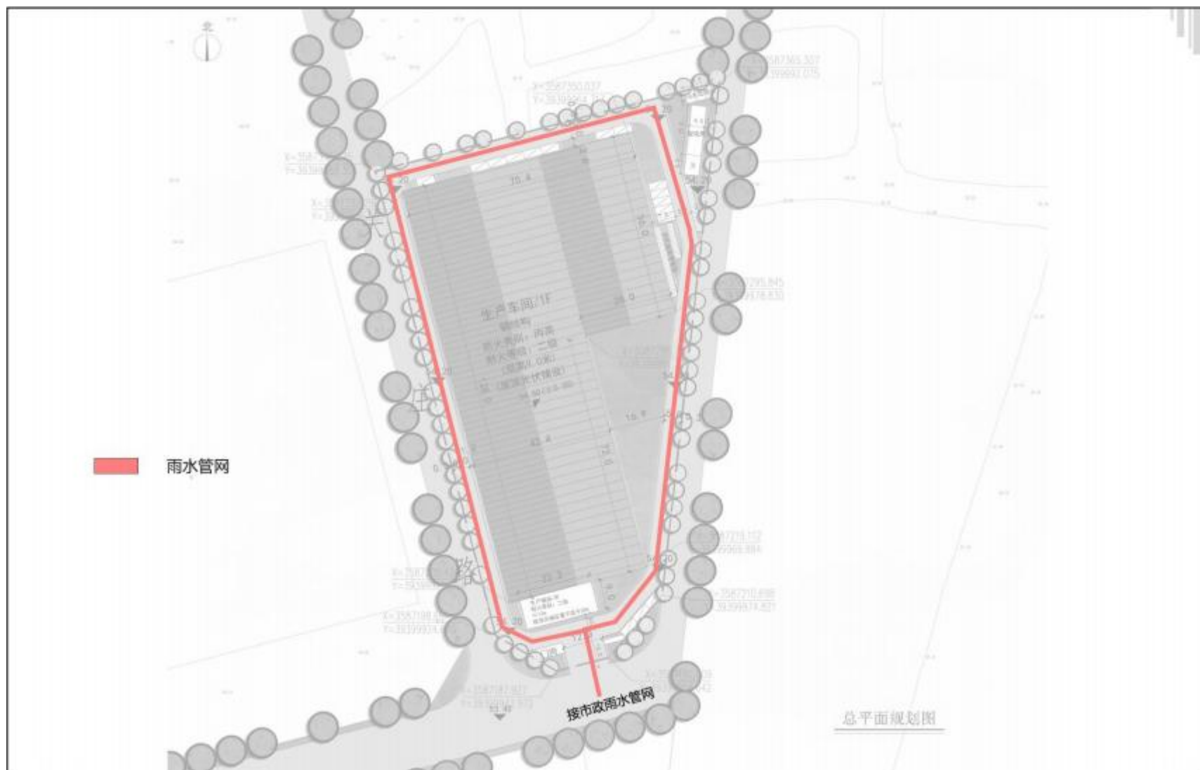
图6.2-7 建设项目雨水管网图
