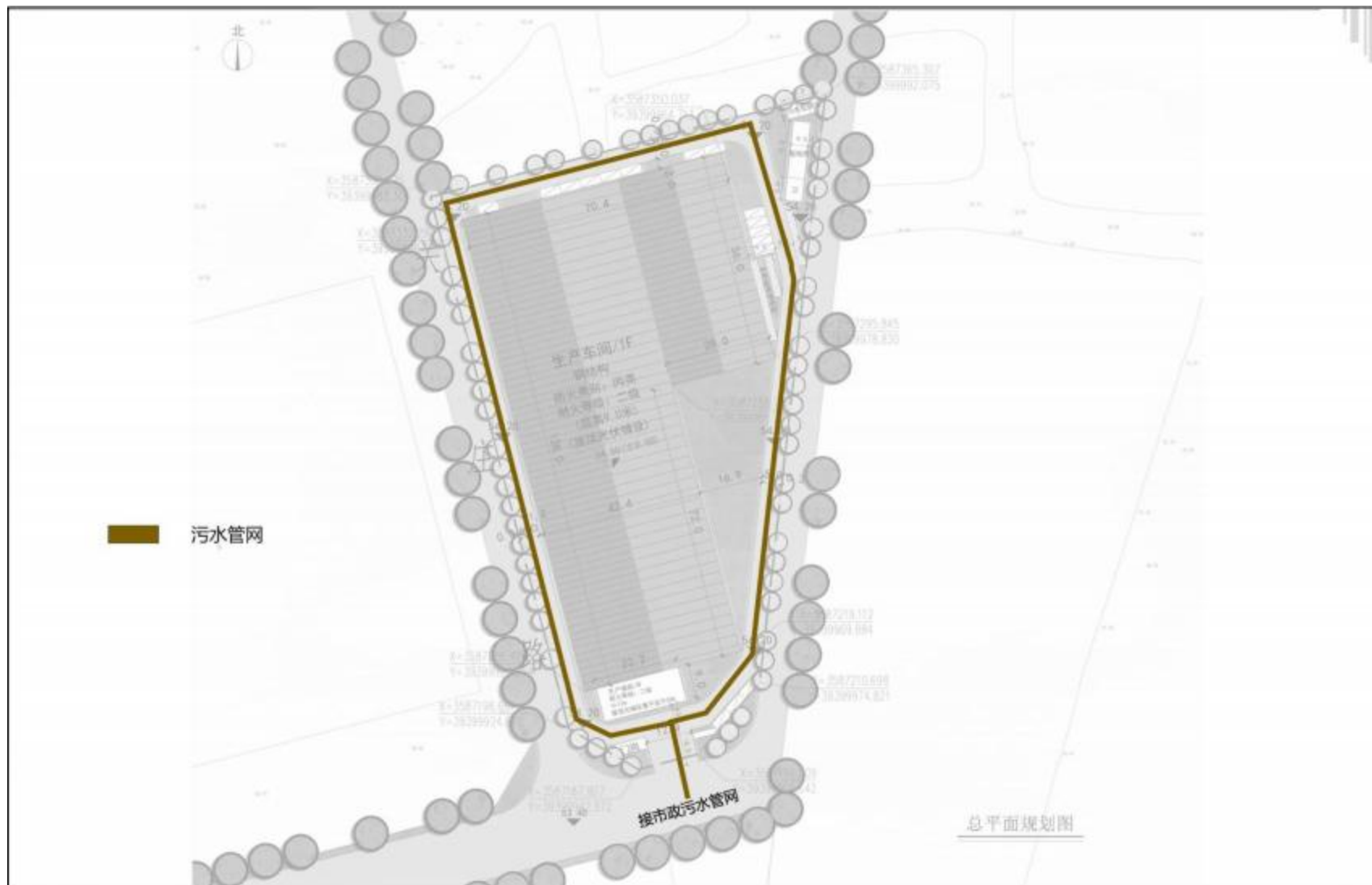
图6.2-8 建设项目污水管网图
