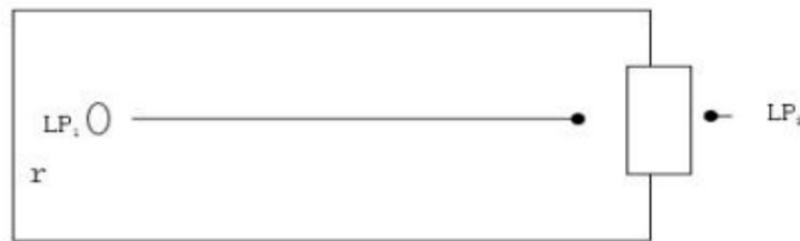
图 4-1 室内声源等效为室外声源图例
