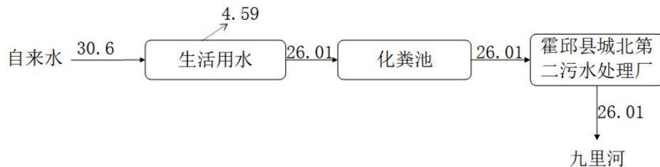
**图 2-1 项目水平衡图 m<sup>3</sup>/d**
